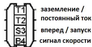
Рис. 15. Контакты разъема X20
